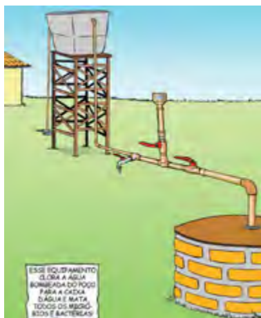
Figuras 7 e 8 – Representação do esquema típico de poço – clorador – reservatório e esquema hidráulico de registros, tubos e conexões
