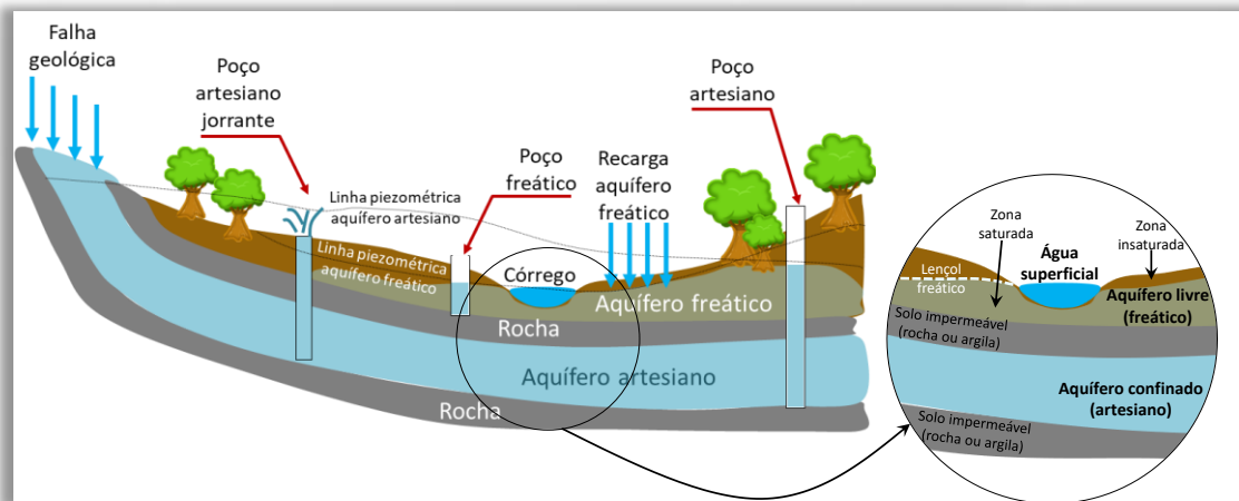
QUADRO 6 – PERFIL LONGITUDINAL DO SOLO A DISPOSIÇÃO DE ÁGUAS SUPERFICIAIS E SUBTERRÂNEAS
